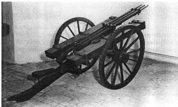
12-lodig treløbet orgelespingol i bloklavet med overrør fra 1838 og 1841. Tøjhusmuseet, museumsnr. A. 726.
